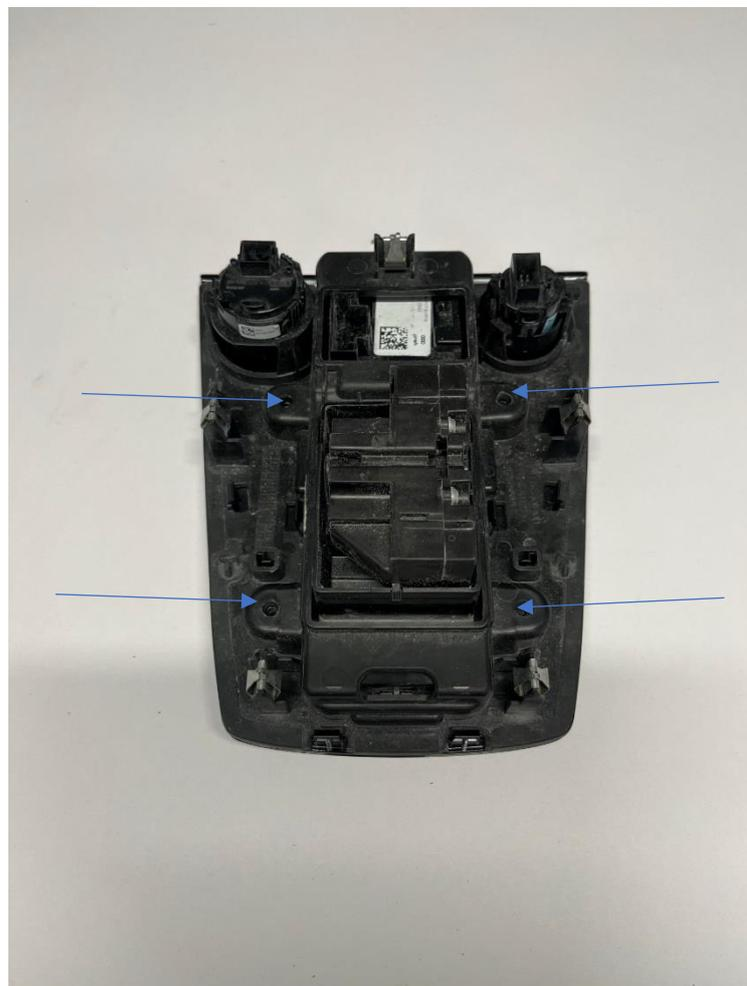
4. Trennen der Ober und Unterseite. Beginnen Sie im unteren Bereich und arbeiten Sie sich nach oben durch. Sobald die unteren und mittleren Klippse gelöst sind können Sie das Unterteil etwas in Richtung Rahmen unterseite herausziehen und die Teile voneinander lösen.
