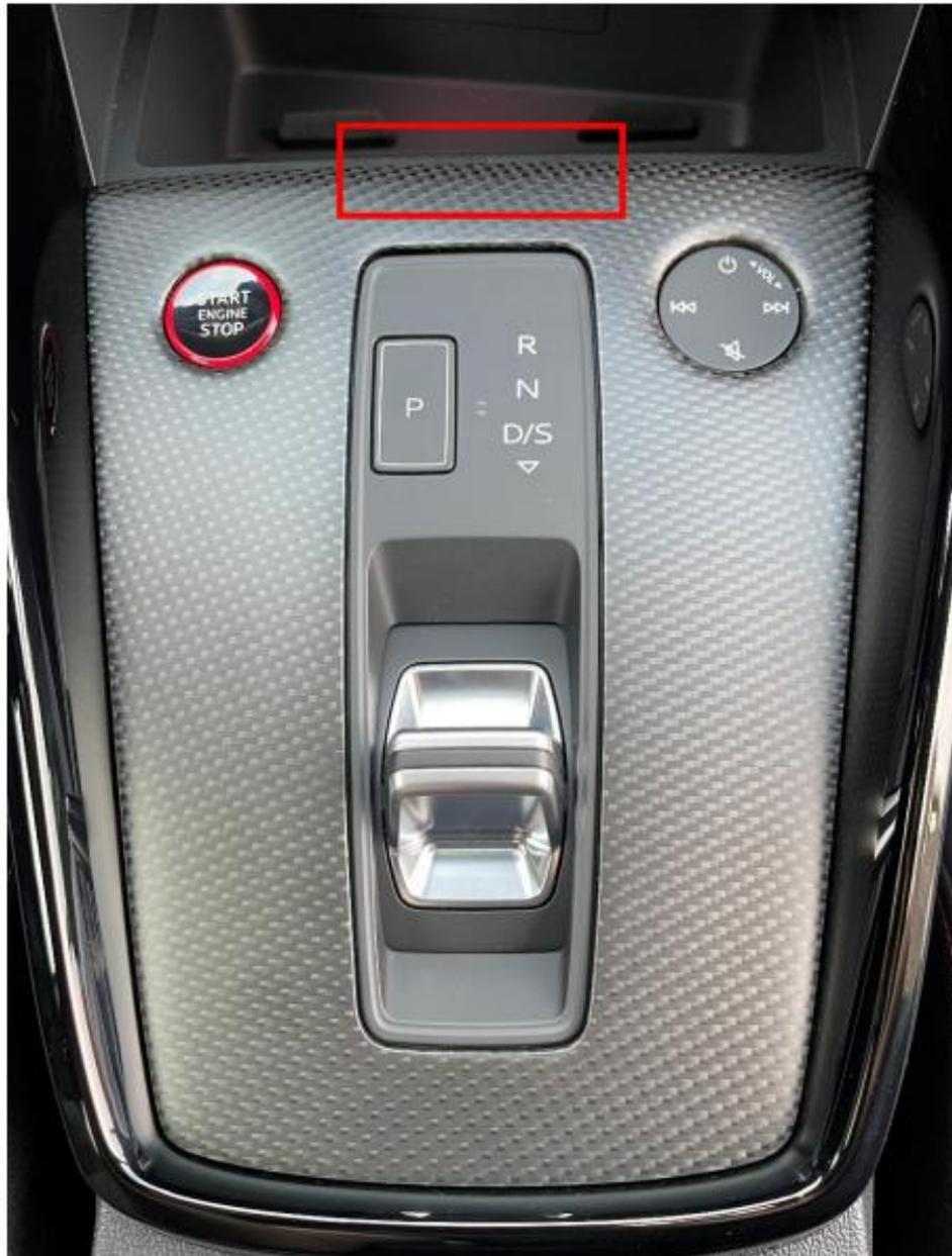
2. Entfernen Sie die 4 Stecker auf Der Rückseite. Nehmen Sie den Rahmen heraus. Die Getriebestecker zusammendrücken und ziehen. Media- und Startknopf den farbigen Stift hoch hebeln, Verriegelung lösen und dann herausziehen.
