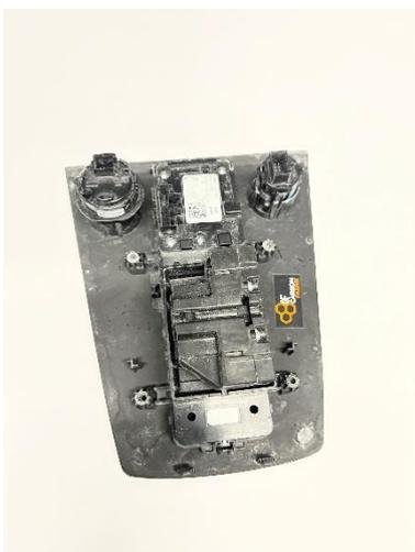
6. Setzen Sie die Rückseite wieder auf. Im Bereich des Media Knopf müssen die Teile leicht aneinander vorbei gewackelt werden. Sobald die Rückseite nahezu bündig an der Vorderseite ist, führen Sie ZUERST die Vorderseite wieder unter die Klippse. Arbeiten Sie hier nicht mit Gewalt, die Teile sollten sich recht einfach ineinander schieben lassen. Es hilft beim zusammenschieben den hinteren Bereich etwas anzuheben.
