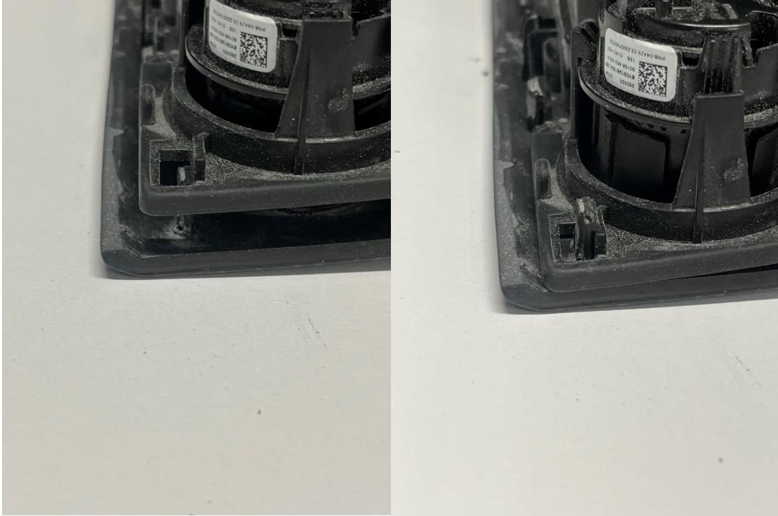
7. Nun muss nur noch der untere Bereich eingeklippt werden. Setzen Sie die Klippse an bis etwas Spannung aufkommt und helfen Sie dann mit den Fingern minimal nach sodass die Klippse über das Unterteil rutschen können. Auch hilft es wenn Sie die Carbonfront mit den Daumen etwas nach unten verschieben sodass die Rahmen besser einrasten. Anschließend installieren Sie die Torx Schrauben wieder und können das Teil montieren.
