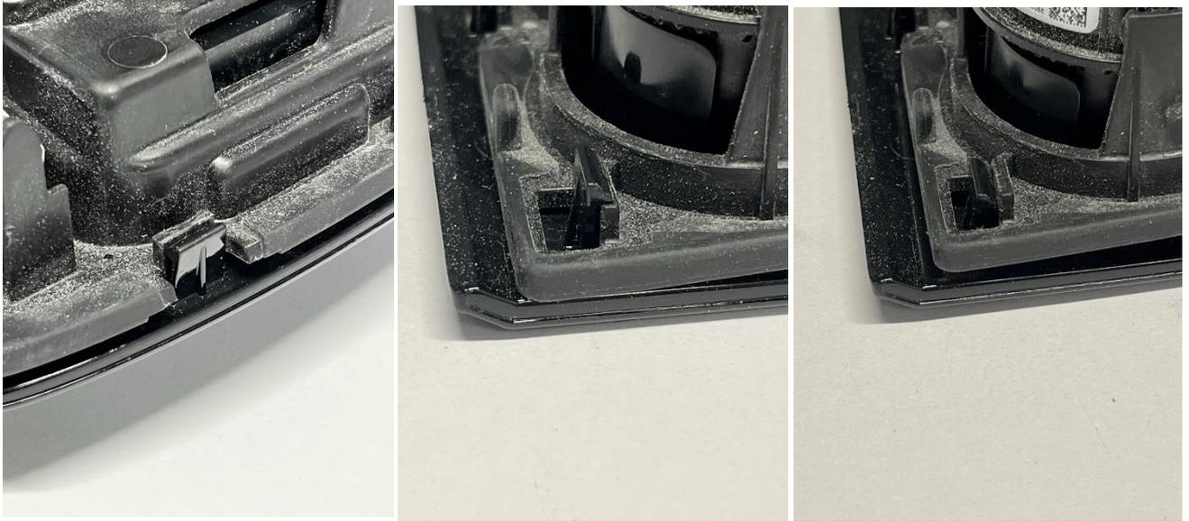
5. Entfernen Sie die Rückseite durch nach oben ziehen und übertragen Sie die Knöpfe und Wählhebel auf das neue Carboneil.
